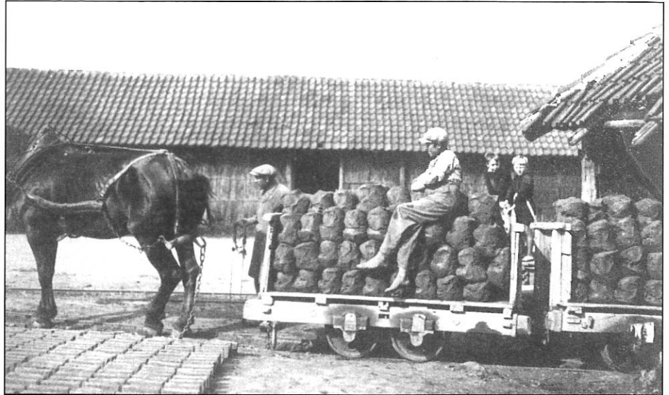
15. Een wagon geladen met "stuiken" of "kloeten" op weg naar de tegelsnijder of de pannenmaker, waar ze eerst werden voorbehandeld door de walker en de inslager voor de pannenmaker of door de vormes voor de snijder (Fotoarchief Gemeente Boom nr. 5087).
