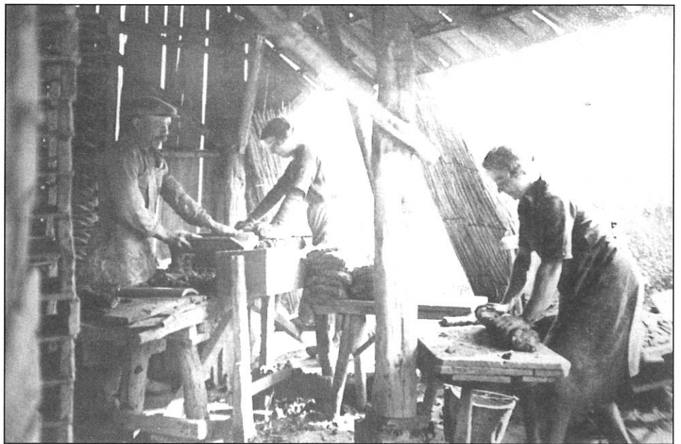
16. De volledige pannenmakersploeg aan het werk. Rechts de walker, in het midden achteraan de inslager, met de klaargemaakte walken op de walkbank aan haar zijde, en links in de schaduw van de pannenblokken de pannenmaker. Bemerkt de rieten matten waarmee op de warme dagen of met harde wind het gevormde goed beschermd werd (Fotoarchief Gemeente Boom nr. 5096).
